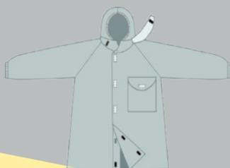
ПЛАЩ С КАПЮШОНОМ ВЫПОЛНЕН ИЗ ОГНЕСТОЙКОЙ ТКАНИ С МЕТАЛЛИЗИРОВАННЫМ ПОКРЫТИЕМ.
